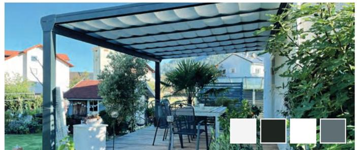
PRIMELINE, variable Dachneigung 5-15°, optionale Rinnenblende (rund, klassik), Wasserablauf unsichtbar im Pfosten integriert, Sondermaße möglich, Dacheindeckungen: Polycarbonat 16 mm oder 8 mm Glaseindeckung (VSG), Rinne und Wandanschluss aus einem Stück (bis 7,95 m Breite)
