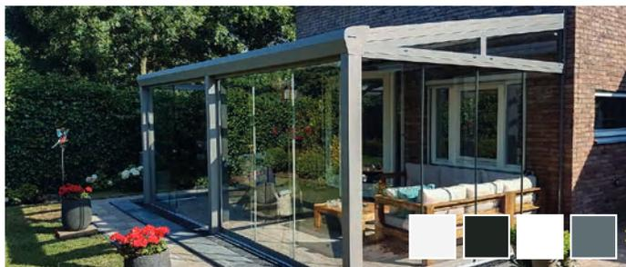
SUPREMLINE, Stabile Rinnenausführung: Pfostenabstand bis zu 6 m, variable Dachneigung 5-15°, Wasserablauf unsichtbar im Pfosten integriert, Dacheindeckungen: Polycarbonat 16 mm oder 8 mm Glaseindeckung (VSG), Rinne und Wandanschluss aus einem Stück (bis 7 m Breite)
